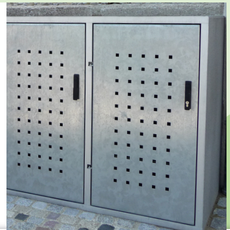
Nach längerer Zeit wittert die frische Zinkfläche ab und es bildet sich die typische matte Zinkoberfläche
